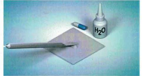
3. Wenn der Zement die gewünschte Konsistenz hat, ist er bereit zum Einfüllen; Verarbeitungszeit insgesamt ca. 5 Minuten.
